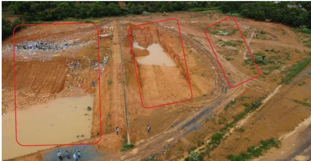
Figura 49: Área Utilizada como Destino Final dos RSUs, com uma Vala (em vermelho) e Previsão de Outras 2 Valas (em vermelho) já Licenciadas
