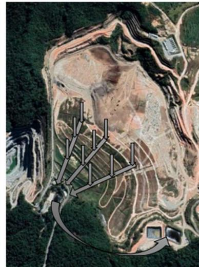
FIGURA 26 – Figura esquemática do encaminhamento do chorume
