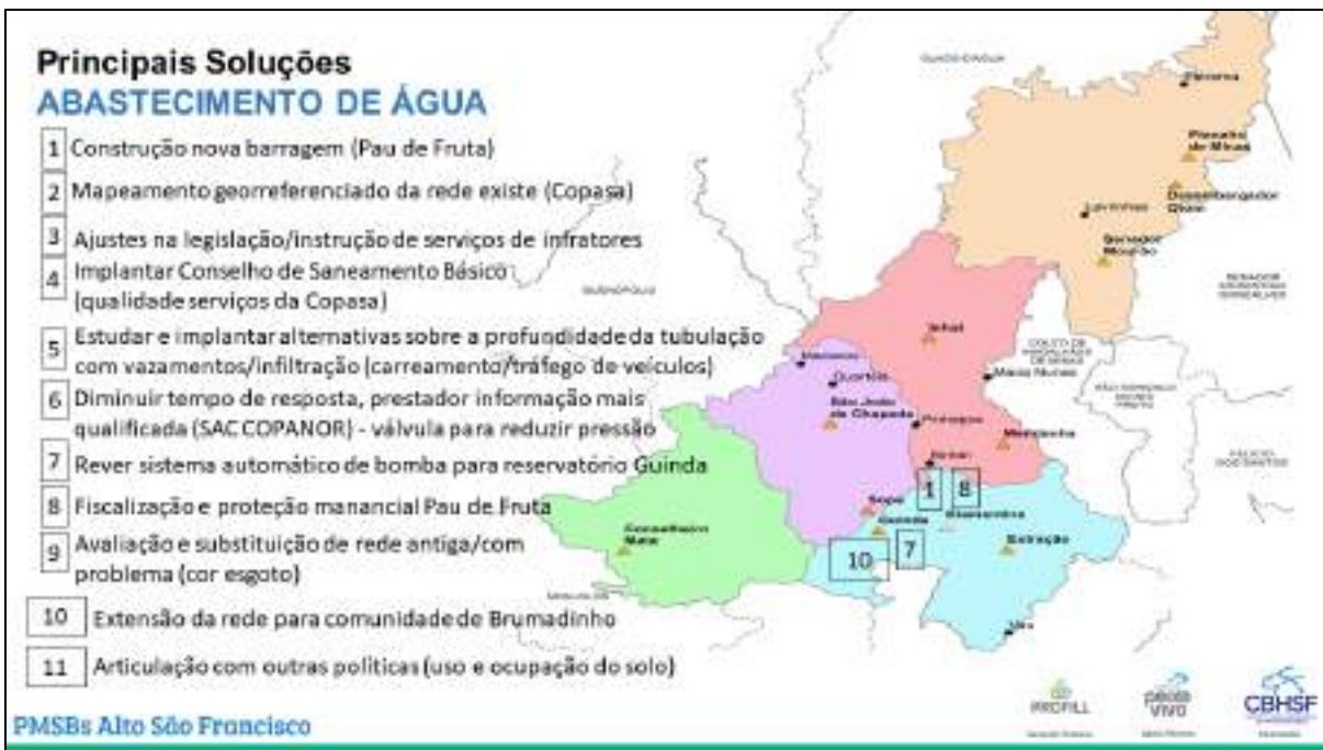
Figura 2 - Principais soluções propostas para o Abastecimento de Água. Fonte: Profill Engenharia e Ambiente, 2021.
