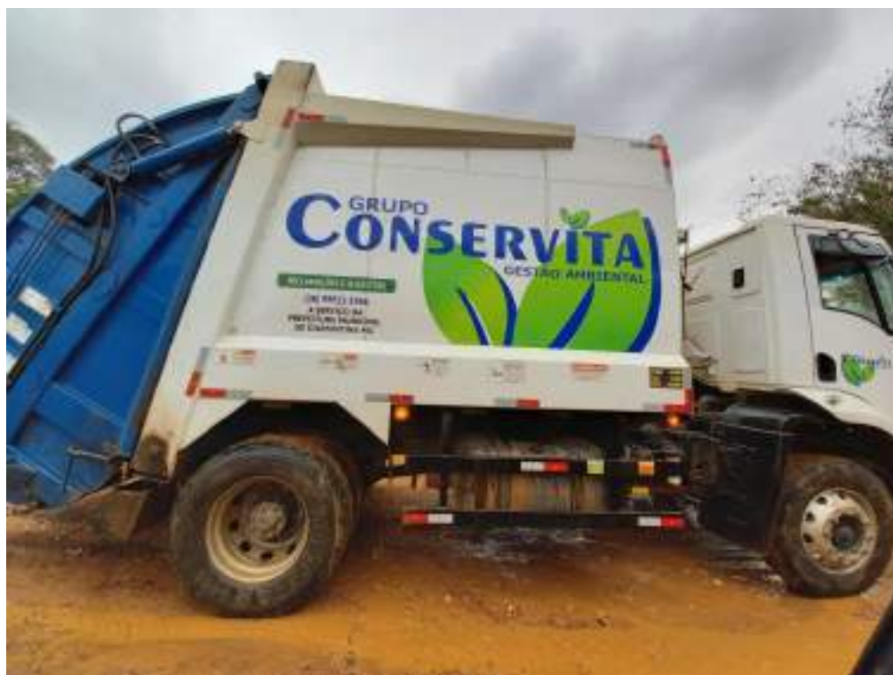
Figura 231 – Caminhão compactador utilizado pela Conservita na coleta comum na sede municipal.
