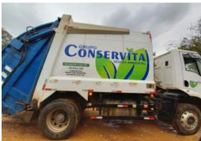
Figura 147 - Caminhão compactador utilizado pela Conservita na coleta comum na sede municipal.
