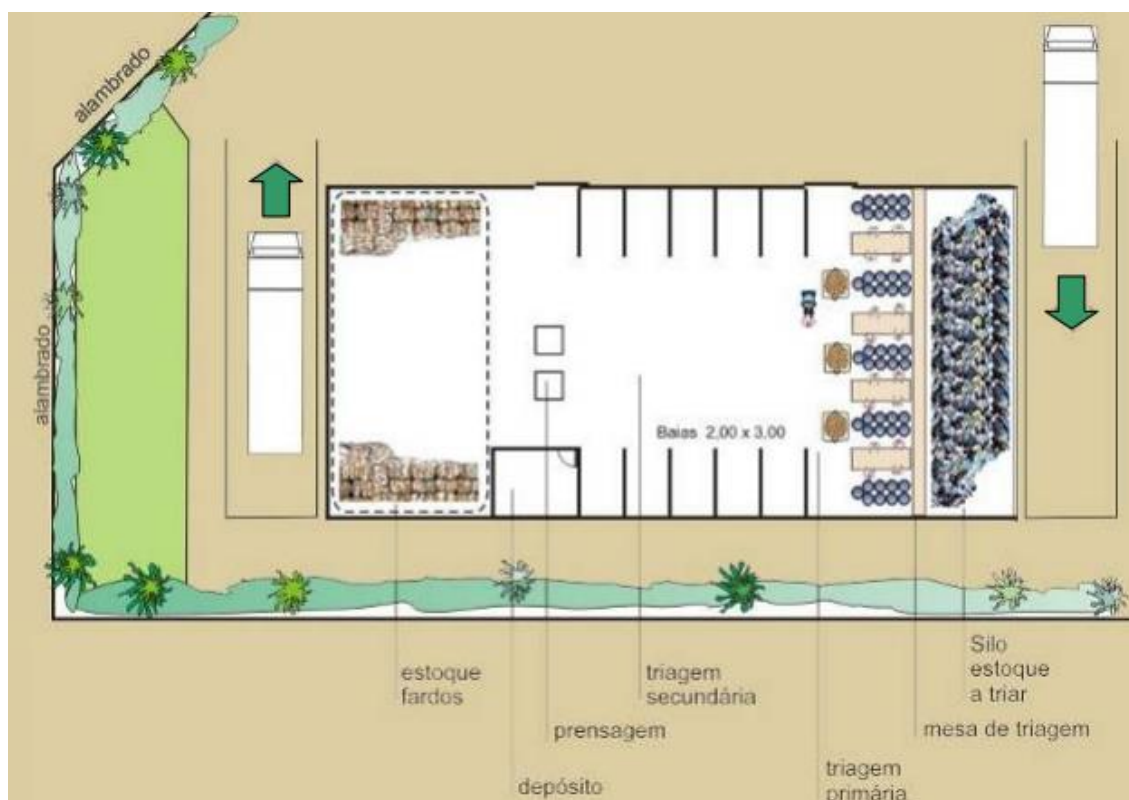
Figura 74 – Planta de um galpão de reciclagem
