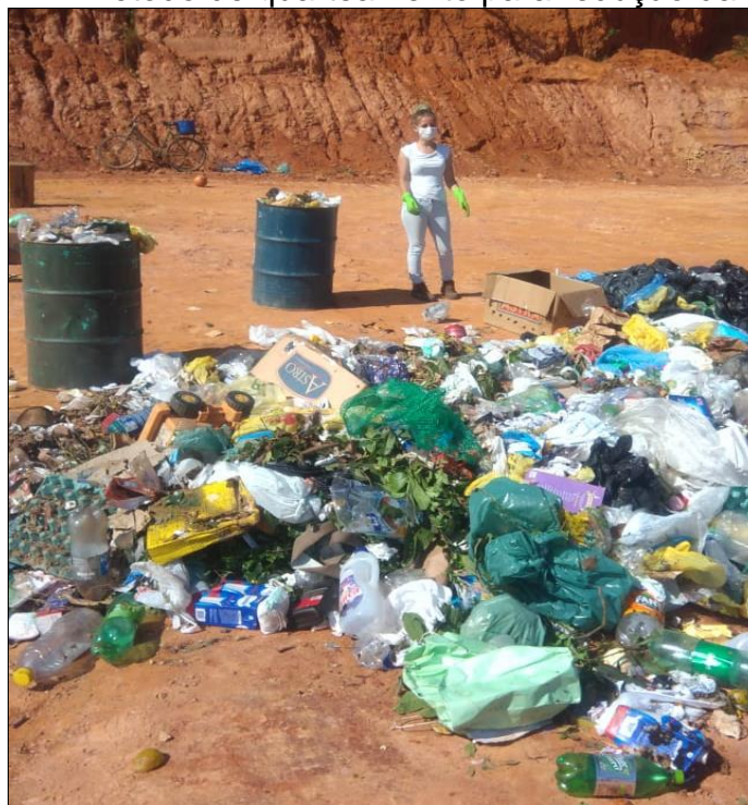
Figura 47 – Método de quarteamento para redução da amostra
