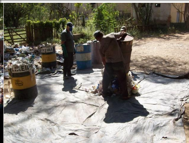
Foto 4: Descarregamento da amostra em cima da lona para determinação da composição gravimétrica
