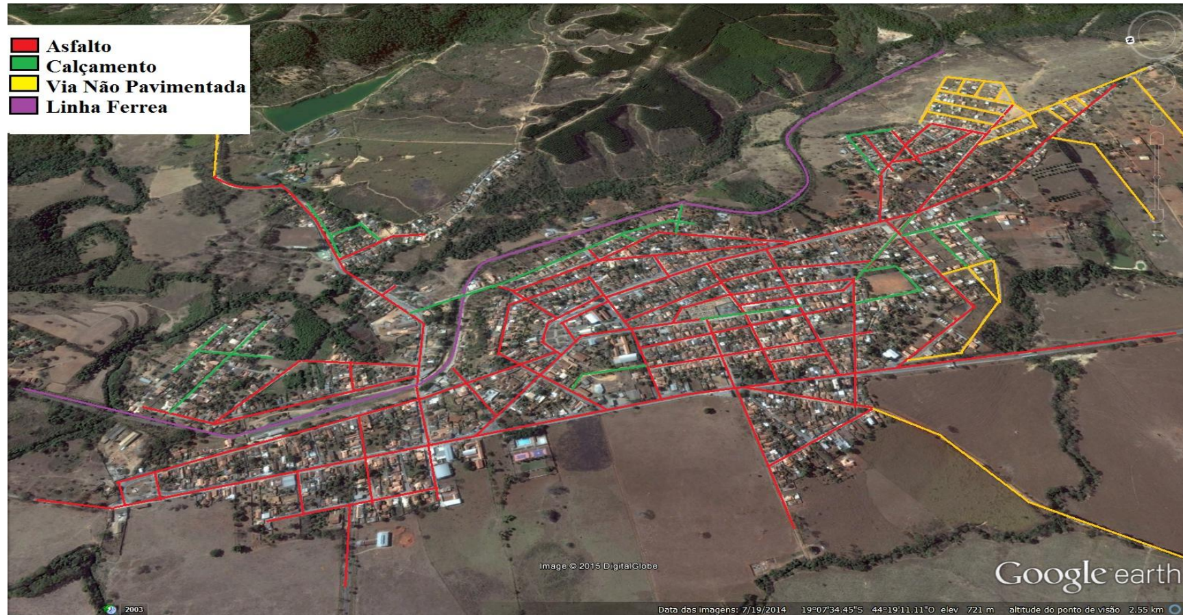
Figura 29: Pavimentação de Cordisburgo Fonte: Google earth
