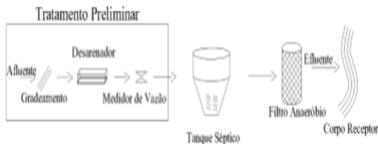
Figura 23: Fluxograma do processo de tratamento na ETE Araçáí Fonte: Prefeitura Municipal De Araçáí, 2015
