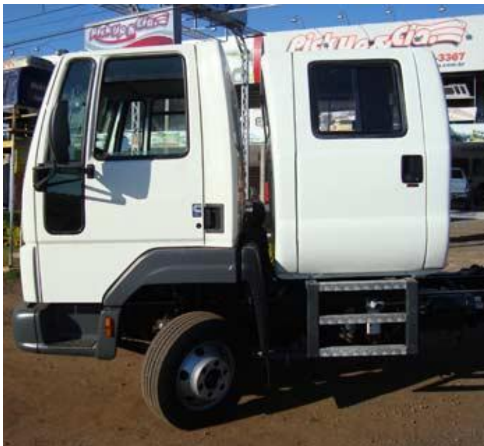
Figura 8.6 – Exemplo de módulo auxiliar para transporte de funcionários adaptado em caminhão
