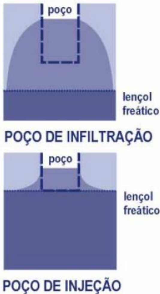
Figura 10.12 – Poço de infiltração e poço de injeção
