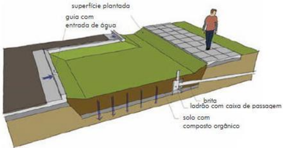
Figura 10.8 – Esquema de um jardim de chuva
