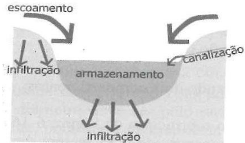
Figura 10.5 – Vala de infiltração
