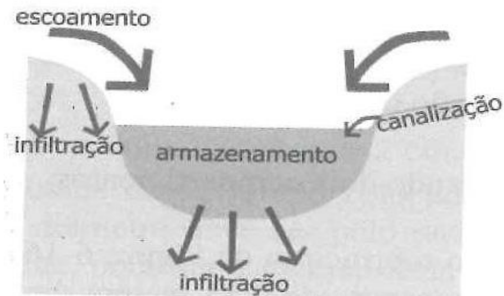
Figura 10.5 – Vala de infiltração
