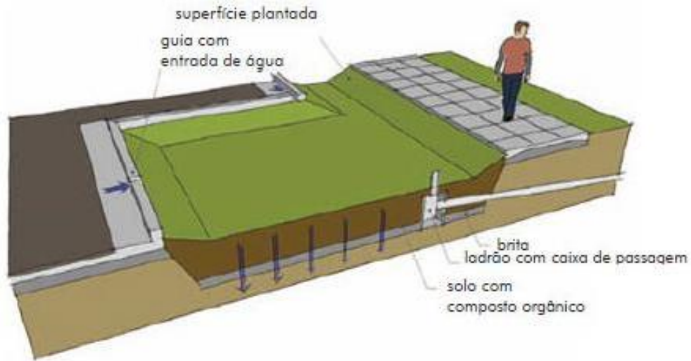
Figura 10.8 – Esquema de um jardim de chuva
