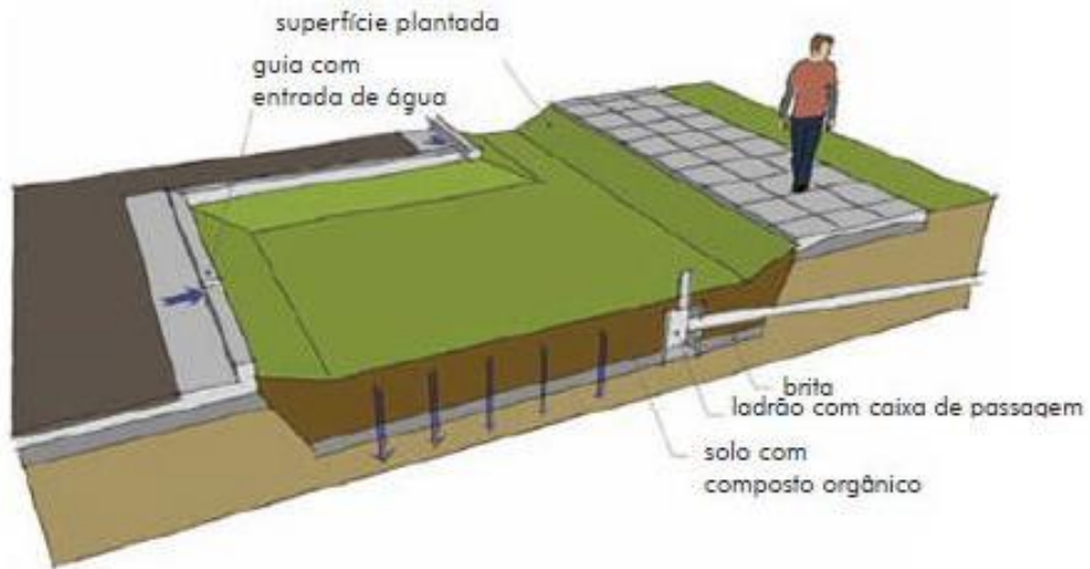
Figura 9.8 – Esquema de um jardim de chuva
