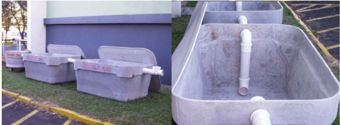
Figura 29: Biodigestor montado: vista lateral e vista superior. Fonte: Embrapa, 2010
