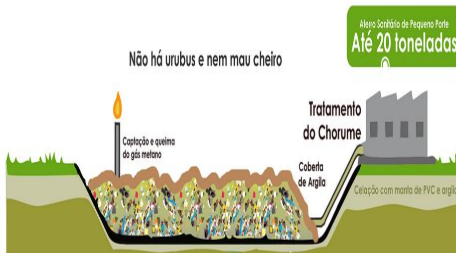
Figura : Aterro Sanitário de Pequeno Porte
