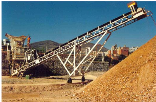
Figura 44: Usina de reciclagem de entulho da Construção Civil Fonte: SLU/CEMP, 2013
