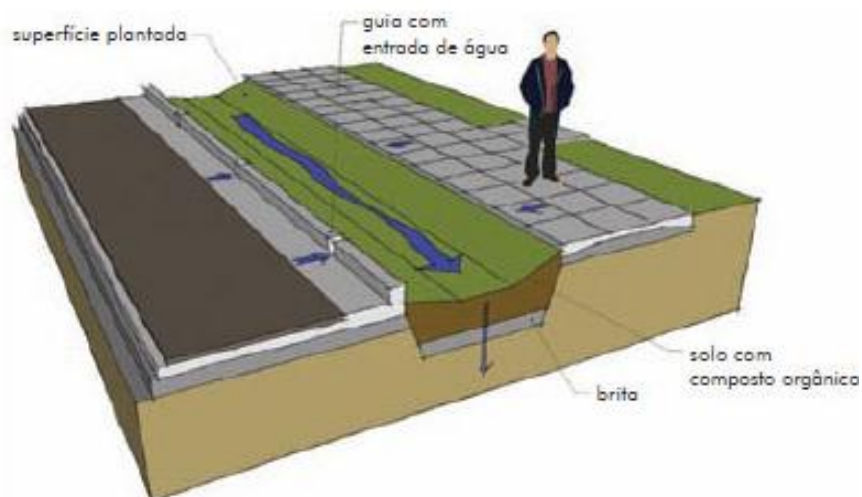
Figura 58: Esquema de Biovaleta Fonte: Cormier, 2014
