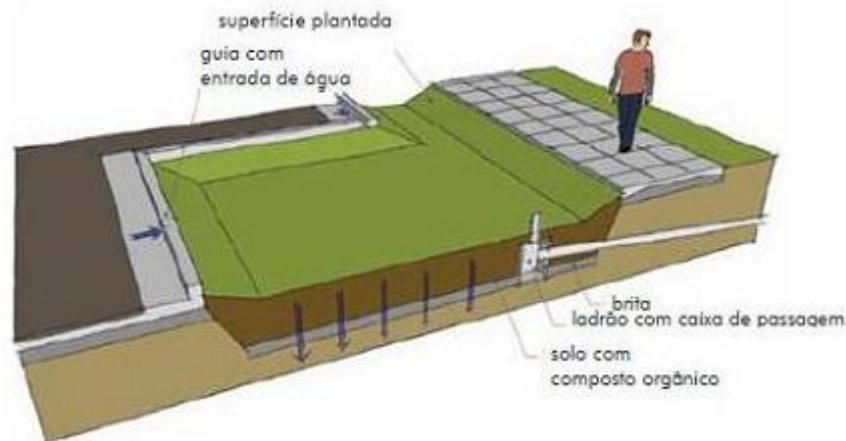
Figura 55: Esquema de um jardim de chuva Fonte: Cormier e Pellegrino (2008)
