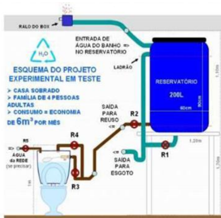
Figura 26: Esquema simplificado de reuso de efluente Fonte: Sociedade do Sol, 2013
