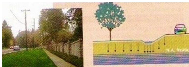
Figura 53: Vala de infiltração Fonte: PROSAB, 2009
