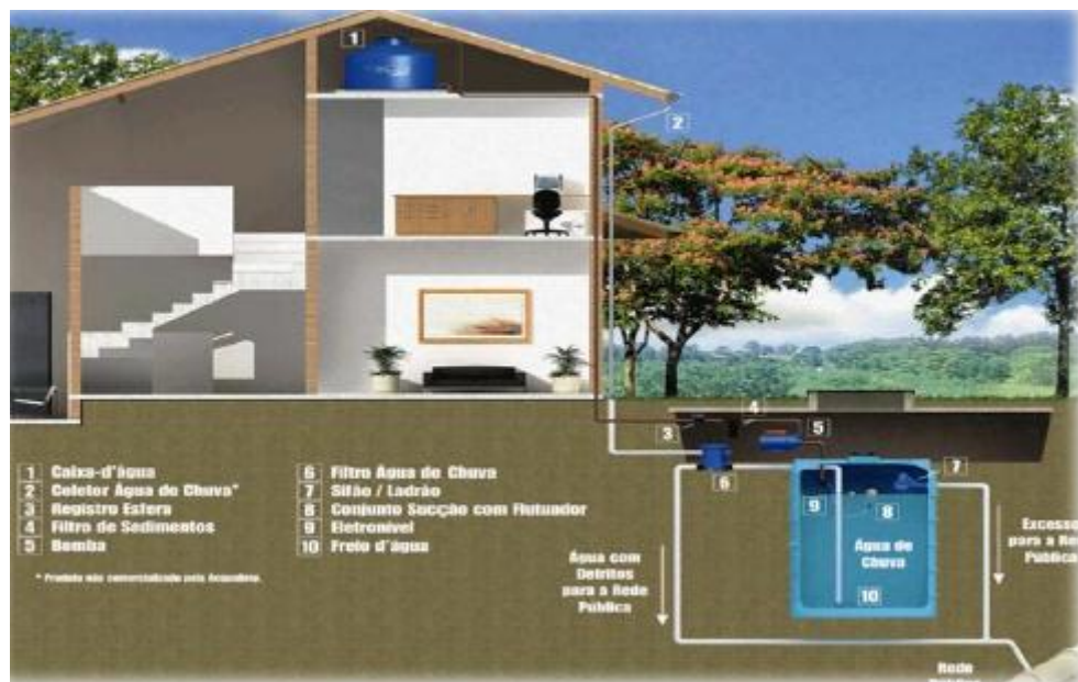
Figura 22: Esquema de captação de água de chuva
