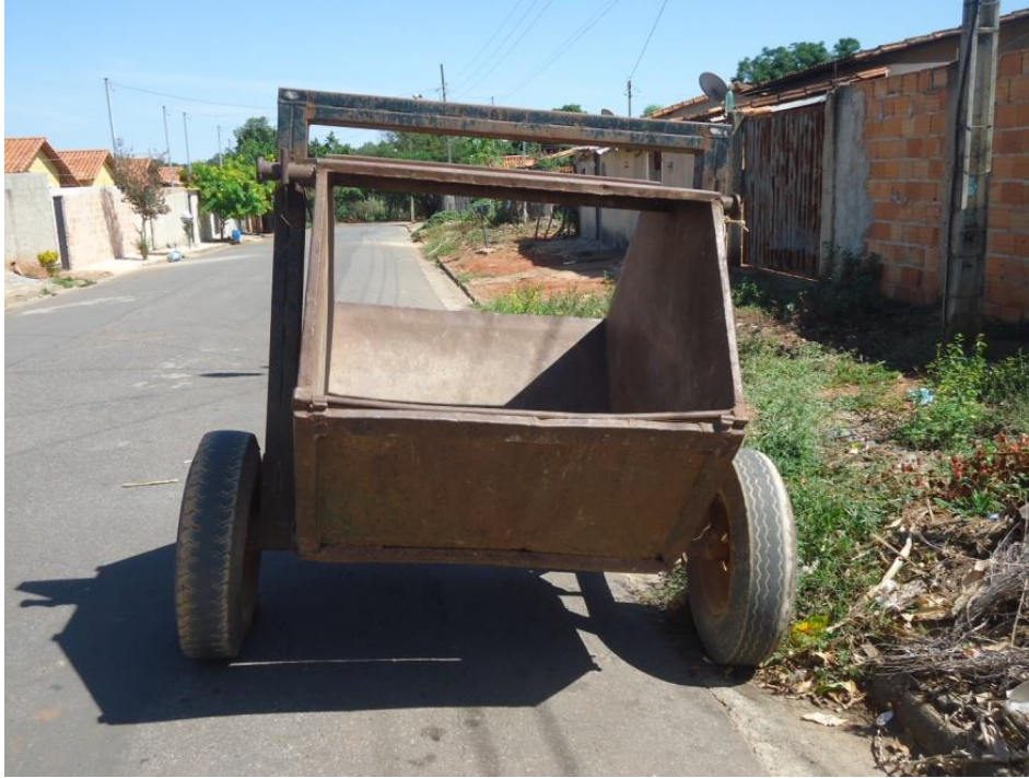
Figura 7.117– Caçamba móvel para RCC
