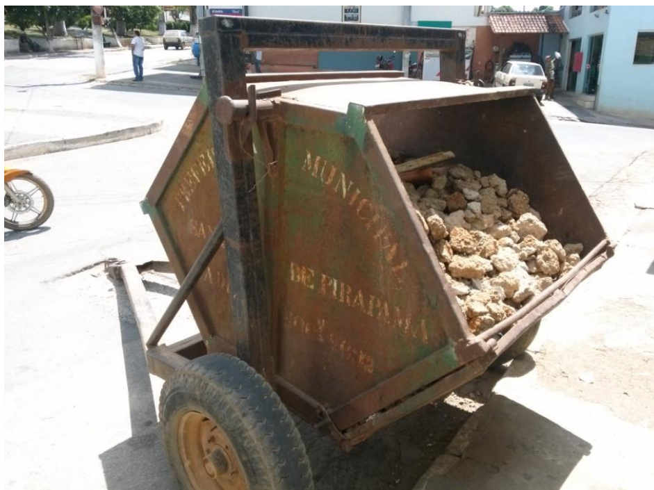
Figura 7.116– Caçamba móvel para RCC
