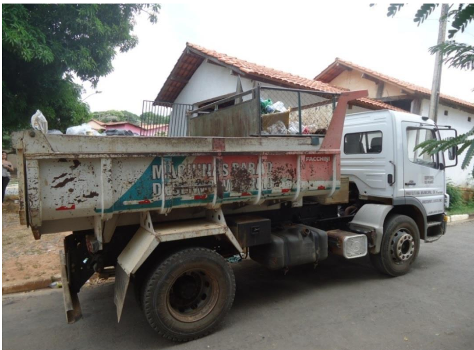
Figura 7.104 – Caminhão basculante utilizado na coleta de resíduos sólidos, detalhe do cesto no basculante destinado aos materiais recicláveis
