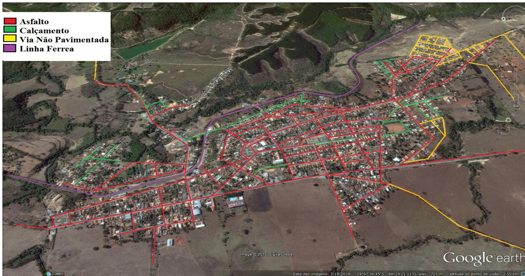
Figura 37: Pavimentação de Cordisburgo Fonte: Google Earth, 2014
