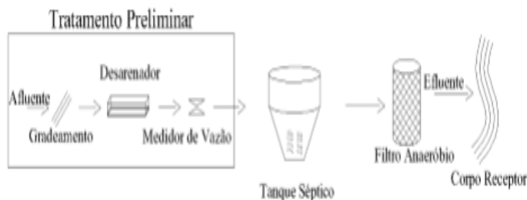
Figura 84: Fluxograma do processo de tratamento na ETE Araçáí
